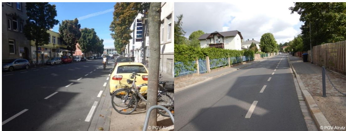
Abb. 14: Links: Schutzstreifen mit Sicherheitstrennstreifen zu parkenden Kfz (Hildesheim); rechts: Einseitiger Schutzstreifen (Radebeul, Moritzburger Straße)
